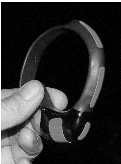
Figuur 1. Halsband met VHF-zender en interne antenne, 35 gram, VHF 153 Mhz, gemaakt door Andreas Wagener Telemetrieanlagen, Keulen (D).
