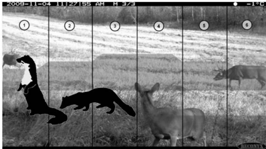
Figuur 2 Ranke marters vallen gemakkelijk door 'de mazen' van de banen in het detectieveld van een cameraal (aangepaste illustratie van Reconyx).
