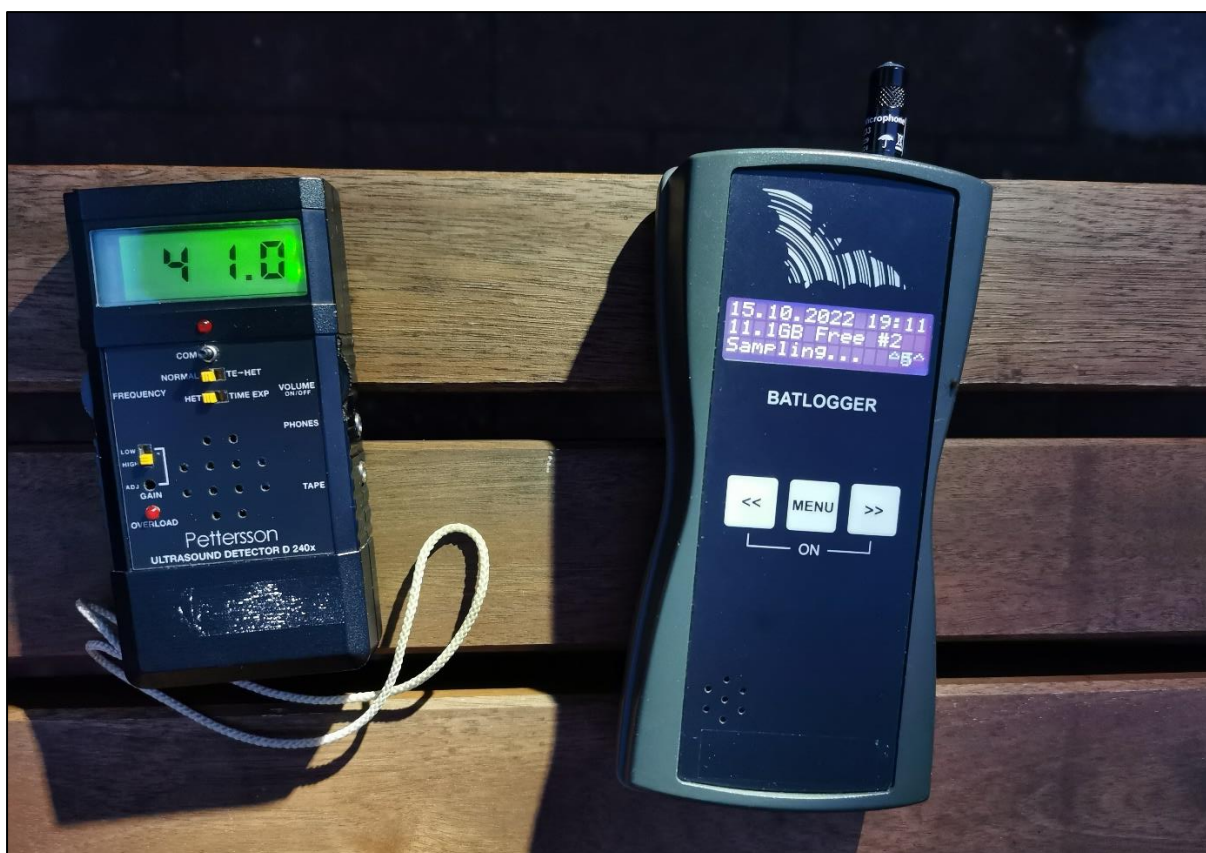
Figuur 8. Twee van de in dit onderzoek geteste batdetectors: links de Pettersons D240x en rechts de Batlogger M van Elekon. Two of the tested batdetectors: Pettersons D240x (left) and Elekon's Batlogger M (right).
