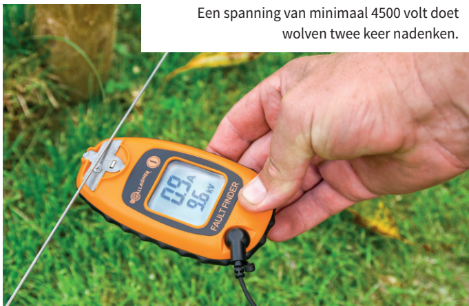
Een elektrische draad op 15 cm hoogte vermijdt dat wolven onder de draad door graven.
